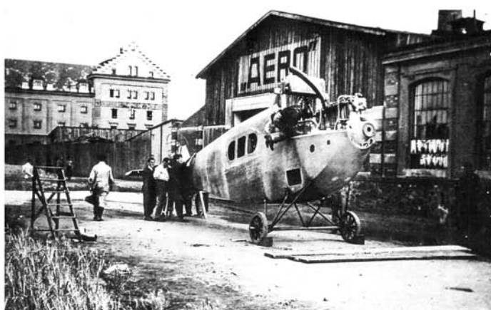
Hala firmy AERO v areálu firmy Al-Ma. Rozestavěné letadlo by mělo být A-8 s motorem Maybach Mb. IV
