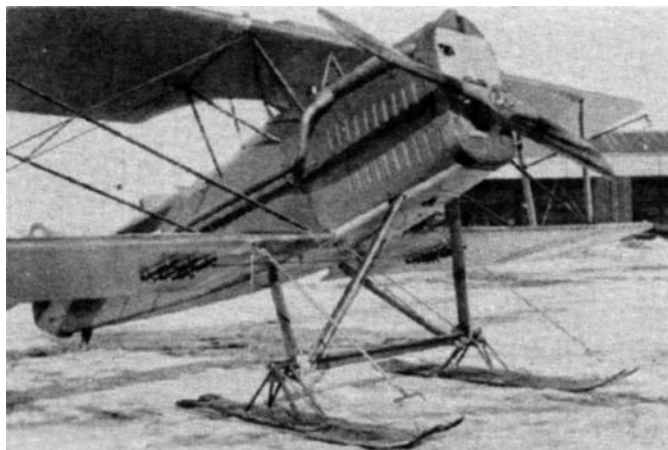
Aero Ab-11 N – zimní úprava podvozku
